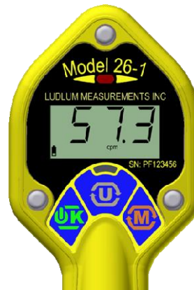
Figure 5: Affichage typique en mode RATE montrant un bruit de fond et l'icône batteries faibles.
