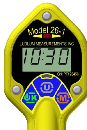
Figure 7: Représentation du mode COUNT, compteur programmé pour 10 minutes et 30 secondes.
